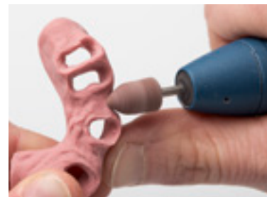
Travaux de finition avec le kit de finition de la technique de thermoformage
